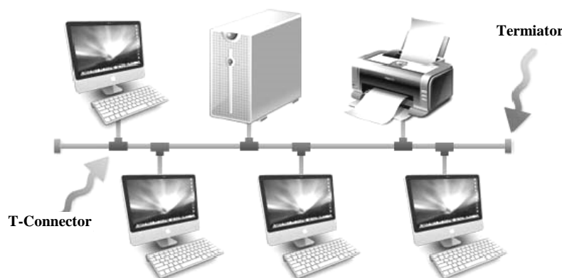
شکل ۱: نمونه‌ای از توپولوژی bus
