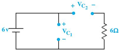
$$V_{c_1}(\circ^-) = V_{c_2}(\circ^-) = 6V$$
