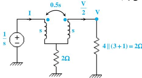
$$\text{حال با اعمال KVL در دو حلقه‌ی موجود داریم: (۱) (حلقه‌ی چپ)} \quad \frac{-1}{s} + sI - 0 / 5s \times \left(\frac{V}{2}\right) + 2 \times \left(I - \frac{V}{2}\right) = 0 \Rightarrow (s+2)I - \left(\frac{s}{4} + 1\right)V = \frac{1}{s}$$
