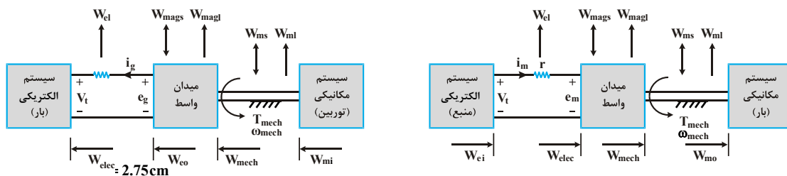
ب) رفتار مولدی یک مبدل الکترومکانیکی
