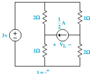
با محاسبه‌ی مقدار  $(0^-)I$ ، می‌توان گفت که به علت عدم وجود کاتست سلفی و منبع ضربه‌ای در مدار داریم  $(0^-)I = I(0^+) = \frac{1}{3}\text{A}$  نیز برابر  $\frac{1}{3}\text{A}$  است. حال مدار را در لحظه‌ی  $t = 0^+$  در نظر گرفته و ولتاژ دو سر سلف را محاسبه می‌کنیم. بدین منظور از جمع آثار استفاده می‌کنیم.
