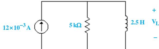
در لحظه‌ی  $t = 0^-$  به دلیل عدم وجود منبع مستقل جریان اولیه‌ی سلف برابر صفر می‌باشد. بنابراین در لحظه‌ی  $t = 0^+$  مدار باز است، در نتیجه ولتاژ سلف در لحظه‌ی  $t = 0^+$  به صورت رو به رو است:
