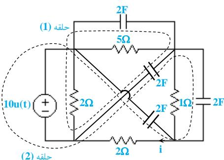
برای محاسبه ولتاژ خازن‌ها می‌توان آنها را با اتصال کوتاه مدل نمود و لذا مقاومت‌های مدار هیچ تأثیری در مقدار ولتاژ خازن‌ها در لحظه  $t = 0^+$  ندارد. حال مطابق شکل زیر داریم:
