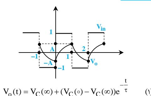
۱۷- گزینه «۳» از آنجایی که مدار از زمان‌های طولانی به منبع  $V_{in}$  وصل بوده است، می‌توان گفت که مقدار متوسط ورودی و خروجی باید برابر باشند. چون مقدار متوسط ورودی برابر صفر است، لذا مقدار متوسط  $V_o$  نیز باید صفر باشد. برای همین، مطابق شکل روبرو، ولتاژ خروجی حالت متقارنی نسبت به محور زمان به خود می‌گیرد:
