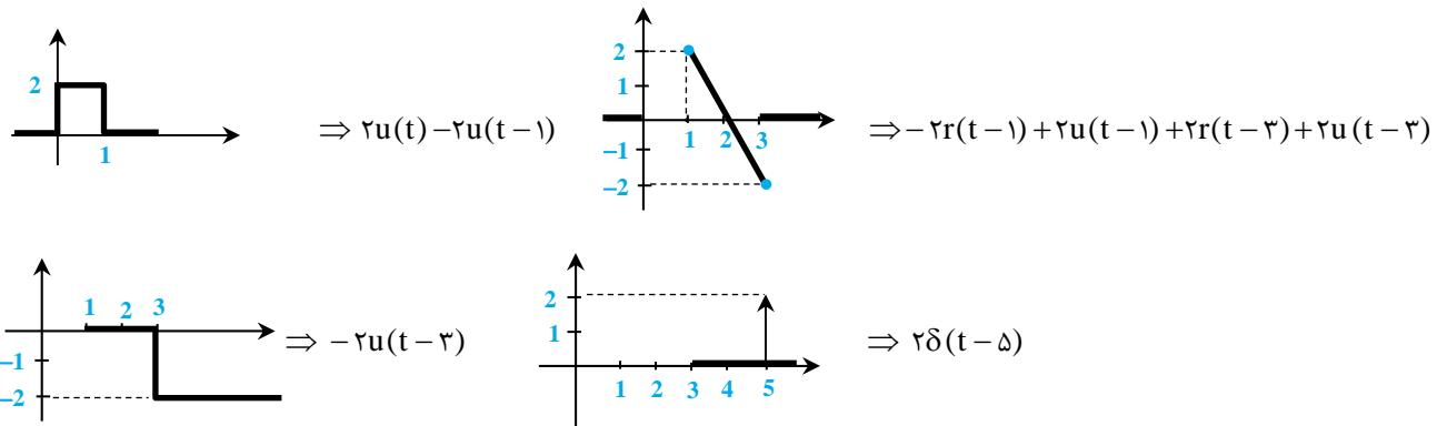
$$f(t) = f_1 + f_v + f_r + f_f = 2u(t) - 2r(t-1) + 2u(t-1) + 2r(t-3) + 2u(t-3) - 2u(t-3) + 2\delta(t-5)$$
