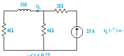
دقت کنید که مدار عاری از منبع ضربه‌ای بوده و داریم:  $i_L(0^+) = i_L(0^-) = 0$ . حال برای تحلیل این مدار، ثابت زمانی آن و مقدار  $i_L(\infty)$  را محاسبه می‌کنیم. برای محاسبه‌ی ثابت زمانی، منبع جریان مدار را غیرفعال کرده و مقاومت مدار را از دو سر  $L$  محاسبه می‌کنیم. برای محاسبه‌ی  $i_L(\infty)$  نیز، سلف را اتصال کوتاه می‌کنیم.
