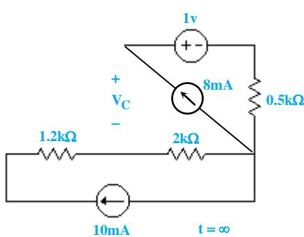
مقدار  $V_C(\infty)$  نیز با مدار باز نمودن خازن محاسبه می‌شود:
