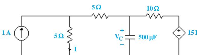
با توجه به فرم پاسخ مدار مرتبه‌ی اول، برای نوشتن معادله‌ی زمانی ولتاژ خازن علاوه بر مقدار اولیه ولتاژ به مقدار نهایی ولتاژ و ثابت زمانی نیاز داریم. از طرفی در زمان بی‌نهایت خازن مدار باز می‌شود. بنابراین داریم:
