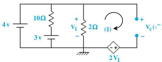
۱- گزینه «۱» ابتدا مدار را برای زمان‌های  $t = 0$  تحلیل می‌کنیم تا مقدار ولتاژ خازن را در لحظه‌ی  $t = 0$  به دست بیاوریم (دقت کنید خازن در لحظه‌ی  $t = 0$  مدار باز است). با توجه به مدار ملاحظه می‌شود:  $v_1 = 4V$  با اعمال KVL در حلقه‌ی ۱ داریم:
