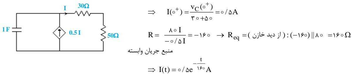
۲۷- گزینه «۲» اثری ذخیره شده در سلف‌ها به جریانشان بستگی داشته و لذا در این تست باید مقدار جریان سلف‌ها در  $t = 0^+$  محاسبه شود. با توجه به اینکه مقدار جریان سلف‌ها در لحظه  $t = 0^+$  وابسته به مقدارشان در لحظه  $t = 0^-$  است، لذا ابتدا مدار را در  $t = 0^-$  تحلیل می‌کنیم:
