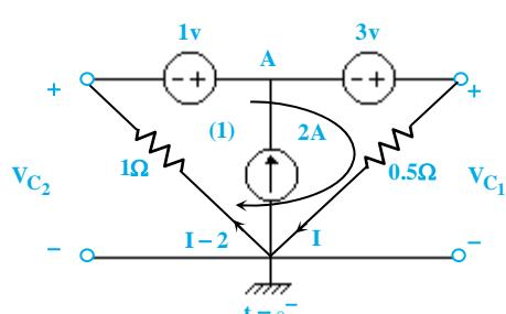
۲۱- گزینه «۱» ابتدا با تحلیل مدار در زمان  $t = 0^-$ ، شرایط اولیه خازن‌های موجود در مدار را بدست می‌آوریم. مطابق شکل با نوشتن رابطه KVL در حلقه (۱) داریم:
