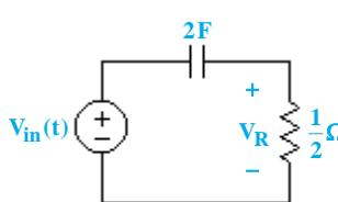
$$\begin{cases} v_R(t) = v_R(\infty) + (V_R(0^+) - v_R(\infty))e^{-\frac{t}{RC}} \\ v_R(0^+) = v_{in}(0^+) = 1 \\ v_R(\infty) = 0 \end{cases}$$
