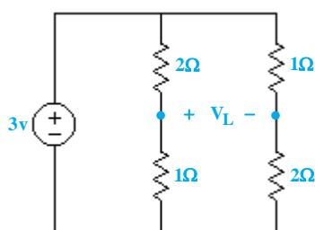
ابتدا با خاموش کردن منبع جریان، مقدار  $V_L$  ناشی از منبع ولتاژ را محاسبه می‌کنیم. با استفاده از قاعده‌ی تقسیم ولتاژ داریم:
