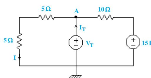
برای به دست آوردن مقاومت دیده شده از دو سر خازن، منبع تستی به جای آن قرار می‌دهیم:
