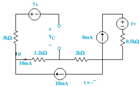
۱۹- گزینه «۱» برای حل تست، ابتدا مدار را در  $t = 0^-$  تحلیل کرده و ولتاژ اولیه خازن را محاسبه می‌کنیم. در این لحظه کلید در وضعیت a قرار داشته و مدار به شکل مقابل خواهد بود:
