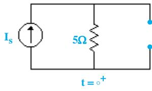
$$\begin{cases} i_L(\circ^+) = 0 \\ i_L(t) = I_S(1 - e^{-\frac{\Delta}{2/\Delta}t}) = I_S(1 - e^{-\tau t}) A \\ i_L(\infty) = I_S \end{cases}$$
