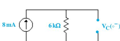
۵۵- گزینه «۲» با توجه به اینکه خازن در لحظهی  $t = 0^-$  مدار باز می‌شود، بنابراین:
