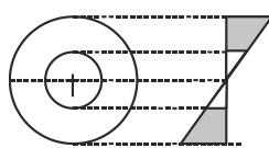
۵- گزینه «۳» در یک شفت توپر، تنش برشی از مرکز (صفر) به صورت خطی تا محیط افزایش می‌یابد. در یک شفت توپر خالی، تنش برشی در شعاع داخلی ( $r_i$ ) صفر نیست، بلکه مقدار مشخصی دارد و تا شعاع خارجی ( $r_o$ ) به صورت خطی افزایش پیدا می‌کند. با عنایت به موارد مطروحة گزینه (۳) نشان‌دهنده شکل درست تغییرات تنش برشی در طول یک تیر است.
