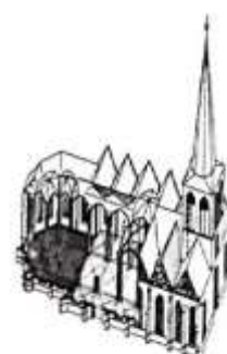
استخوان‌بندی کلیساهای گوتیک. دیاگرام ارتباط عناصر سازه‌های طاقی شکل در معماری کلیساهای گوتیک. دیاگرام انتقال نیروهای طاق‌های شبستان به پشت‌بندها
