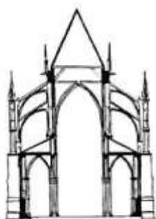
استخوان‌بندی کلیساهای گوتیک. دیاگرام ارتباط عناصر سازه‌های طاقی شکل در معماری کلیساهای گوتیک. دیاگرام انتقال نیروهای طاق‌های شبستان به پشت‌بندها
