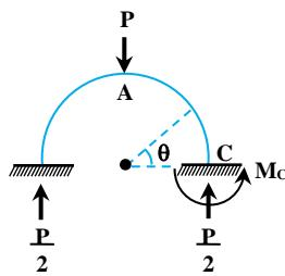
۱- گزینه «۱» بدلیل تقارن تنها نیمی از سازه را مورد بررسی قرار می‌دهیم، همچنین بدلیل تقارن، زاویه در مقطع C مساوی صفر بوده و نیروی تکیه‌گاهی برابر  $\frac{P}{2}$  است. به دلیل صفر بودن شیب در مقاطع B و C می‌توان در مقاطع مذکور، تکیه‌گاه گیردار فرضی در نظر گرفت. در یک زاویه دلخواه  $\theta$  از مقطع C لنگر داخلی برابر است با:
