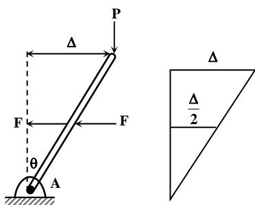
۳- گزینه «۳» اگر ستون صلب از وضعیت قائم به اندازه زاویه کوچک  $\theta$  منحرف شود آنگاه با گشتاور گیری نیروها حول مفصل A نیروی  $P$  بحرانی بدست می‌آید.
