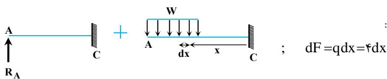
اکنون با استفاده از روش جمع آثار خیز نقطه  $C$  تعیین می‌شود:
