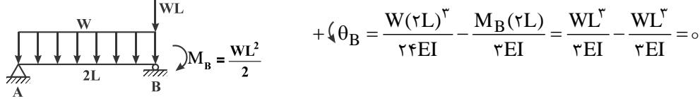
۲- گزینه «۱» دو تیر AB و BC مانند دو فنر موازی عمل می‌کنند. برای محاسبه خیز مقطع B می‌توان از این نکته به صورت زیر استفاده کرد:
