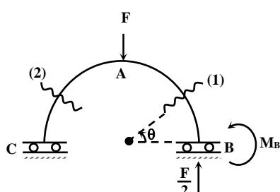
۳- گزینه «۴» بدلیل تقارن شکل تنها نیمی از سازه را مورد بررسی قرار می‌دهیم. به دلیل تقارن در مقاطع B و C شیب حلقه مساوی صفر بوده بنابراین می‌توان در این مقطع تکیه‌گاه گیردار فرضی در نظر گرفت. اکنون در نیم حلقه مطابق شکل دو برش زده و لنگر داخلی در آنها محاسبه می‌شود:
