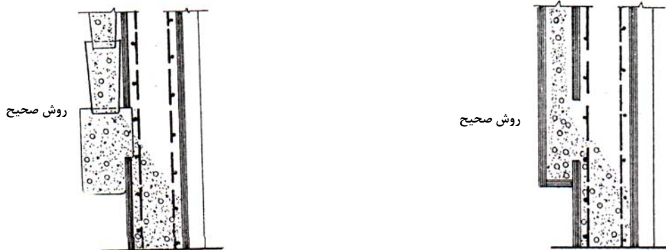
«شکل ۱-۲. بتن‌ریزی از روزنه»
