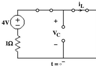
۱۷- گزینه «۴» ابتدا با تحلیل مدار در  $t = 0^-$ ، شرایط اولیه مدار را به دست می‌آوریم. در این لحظه خازن مدار باز و سلف اتصال کوتاه است:
