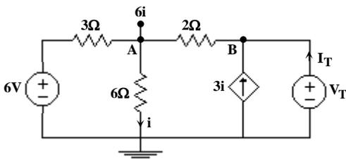
۱۴- گزینه «۱» باید مدار معادل تونن را از دو سر a و b پیدا کنیم. برای این کار منبع ولتاژ تست  $V_T$  را در دو سر a و b قرار داده و رابطه  $V_T$  با  $I_T$  که جریان عبوری از منبع می‌باشد را به‌دست می‌آوریم:
