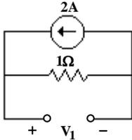
۱۶- گزینه «۲» در گام اول ولتاژ  $V_1$  را در لحظه‌ی صفر محاسبه می‌کنیم. در  $t < 0$ ،  $i_S$  برابر ۲ آمپر بوده و وضعیت در وضعیت OA قرار دارد. با فرض آن که مدار در حالت دائمی باشد، خازن همچون مدار باز عمل کرده و داریم:
