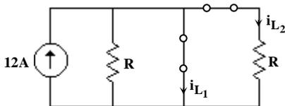
۱۳- گزینه «۳» ابتدا مدار را در حالتی‌که کلید بسته است، تحلیل کرده و جریان سلف‌ها را محاسبه می‌کنیم. در این وضعیت با فرض آن‌که مدار در حالت دائمی باشد، سلف‌ها همچون اتصال کوتاه عمل می‌کنند. بنابراین مدار به شکل روبه‌رو مدل می‌شود:
