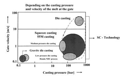
پردازش نیمه جامد می تواند مزایای زیادی داشته باشند زیرا هیچ گونه کنترلی روی فلز مایع وجود ندارد و به خاطر اینکه جریان فلز درون حفره قالب نسبت به جریان نیوتنی، به جریان بینگهام خیلی نزدیک تر است. شکل زیر شماتیکی از دست یافته هایی در مجموعه بازار پردازش نیمه جامد در مقایسه با بازار غیر سودمند برای ریخته گری ها و فلزکاری ها نشان داده شده است.
